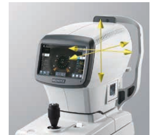
Mecanismo de manejo 3D para autoenfoco
